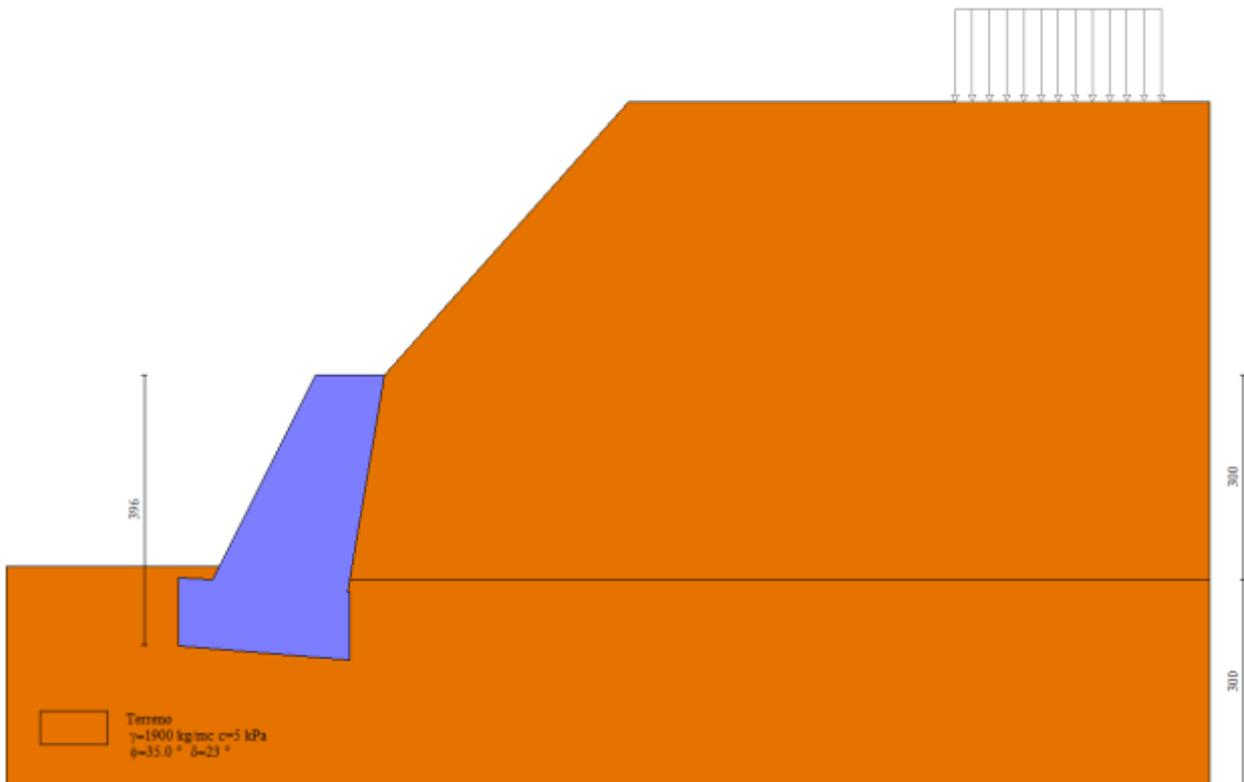
Figura 16 - Estratto dal software di calcolo MAX 16.0 – Sezione di verifica – Intervento Strada Canavero
