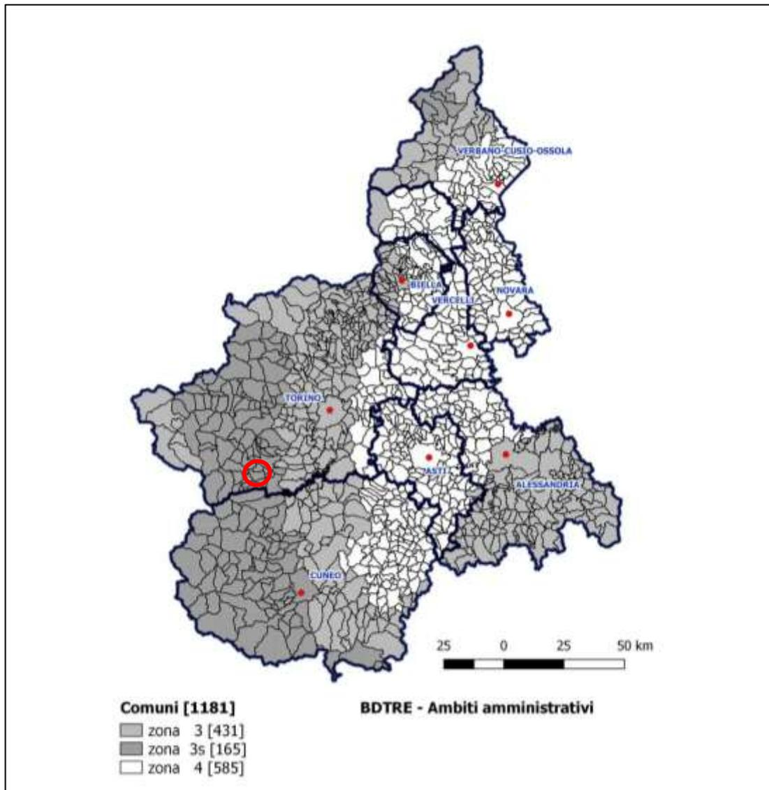
Figura 12 - Mappatura delle aree sismiche in Piemonte.
