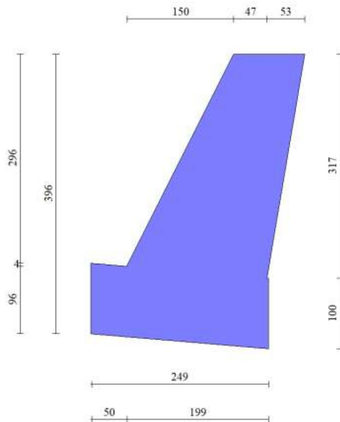
Figura 15 – Estratto dal software di calcolo MAX 16.0 – Sezione di verifica – Intervento – Strada Canavero
