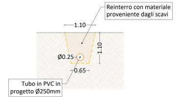
**SEZIONE TRASVERSALE POZZETTONE**
